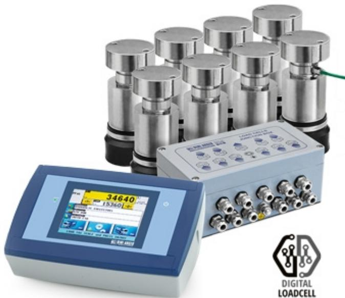
Kit per la realizzazione di pese a ponte digitali, composto da indicatore di peso touch screen 3590ETD con programma AF03 specifico per pese a ponte, 8 celle di carico digitali DINI ARGEO serie "RCPTD", IP68, complete di giunti oscillanti di appoggio in acciaio zincato e scatola di equalizzazione digitale, con surge arresters.
